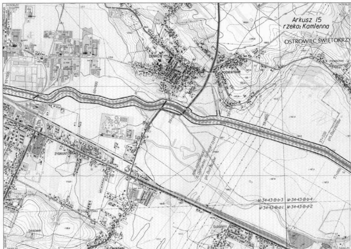
Rys. 1. Tereny zalewowe rzeki Kamiennej – cz.1 i cz.2.
