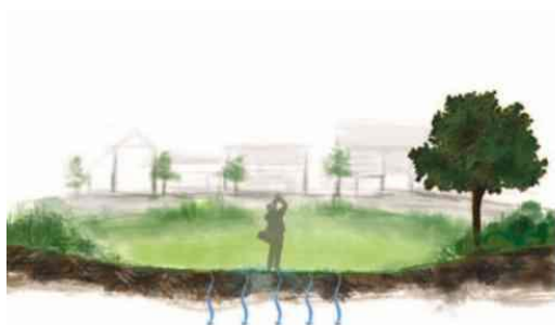
Ryc. 6 Schemat niecki chłonnej na terenie otwartym i przykład na terenie silnie zabudowanym (osiedle Portland, Stany Zjednoczone), (Iwona Wagner, 2014)
