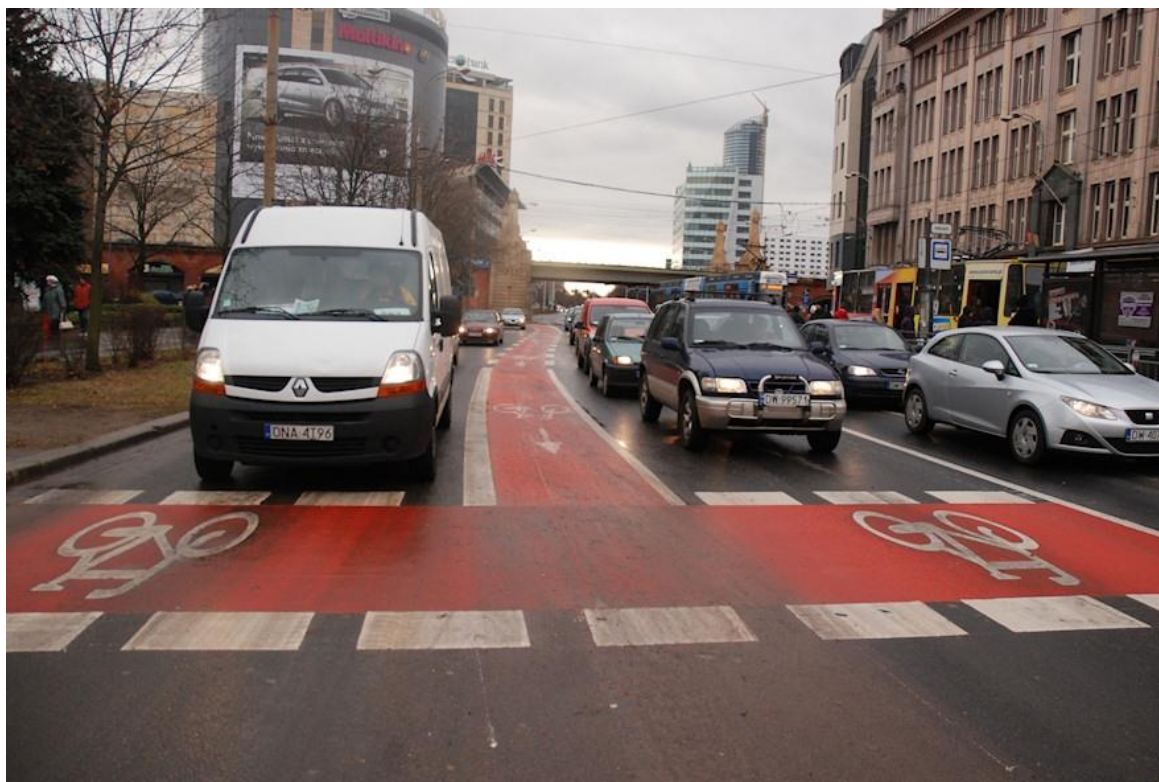
Ryc. 35 Pas rowerowy zakończony służą rowerową. Źródło: Pasy, kontrapasy oraz służy rowerowe we Wrocławiu - wRower.pl - Rowery od A do Z
