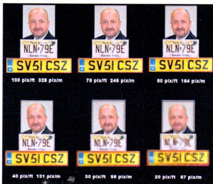
Rysunek 4. Różne parametry jakościowe w technologii mega pikselowej – piksele na metr
