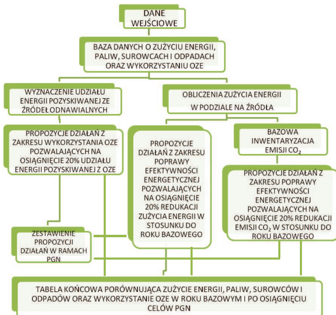
Rysunek 8. Metodyka sporządzania bilansu energetycznego oraz emisji gazów cieplarnianych w podziale na grupy odbiorców [źródło: opracowanie własne]
